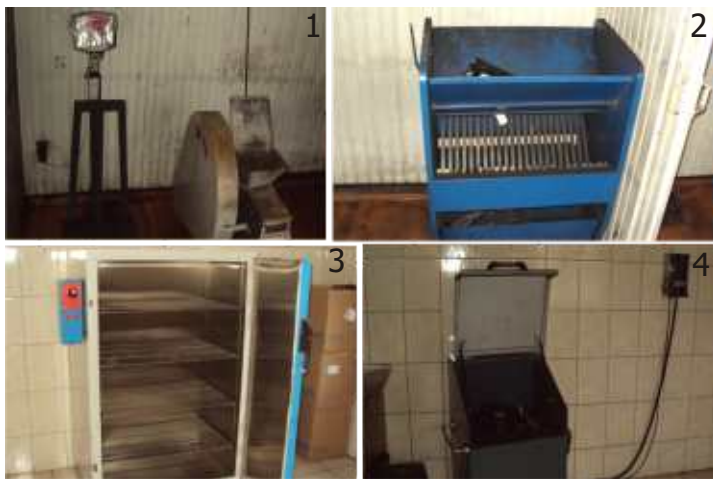
Şekil 1. Numune hazırlama aşamasında kullanılan cihazlar, 1. Çeneli kırıcı, 2. Bölücü, 3. Etüv, 4. Titreşimli değirmen
