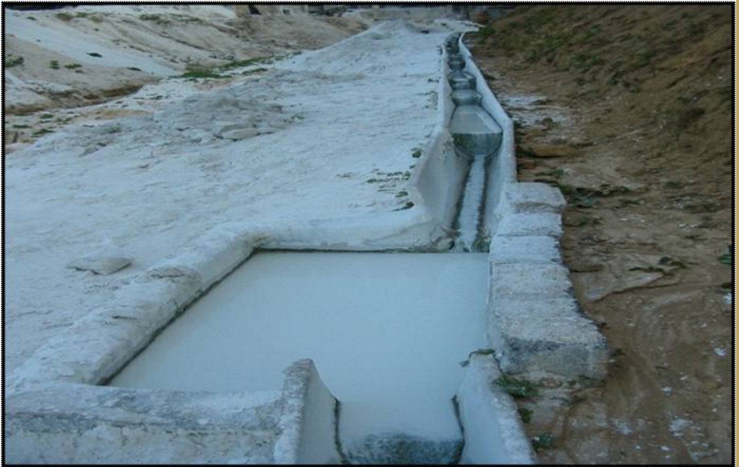
Şekil 4. Süspansiyon halindeki malzemeyi taşıyan ve silisin ve demirin malzemedan alındığı kaolen işletmesindeki oluklar
