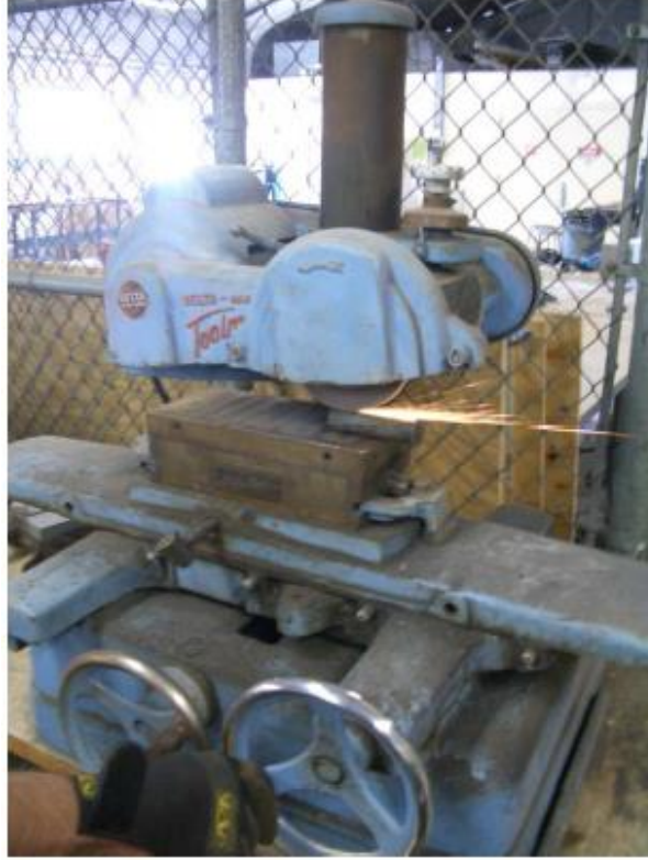
Şekil 14. Taşlama Tezgahında numunenin taşlanması genel görünüşü (Patel, 2008)
