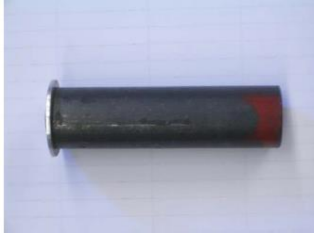
Şekil 16. Jominy deney numunesi genel görünüşü (Patel, 2008)
