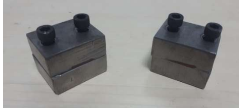
Şekil 10. Ek kütleler ( M_2 ya da m = 0.284 \text{ kg} )
