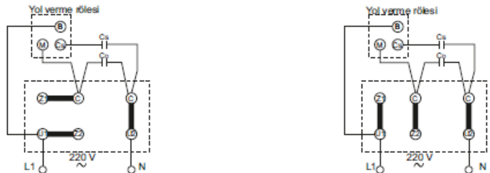
Şekil: Tek faz motorun sağa ve sola çift kapasitör ve yol verme rölesi ile klemens bağlantı tablosu
