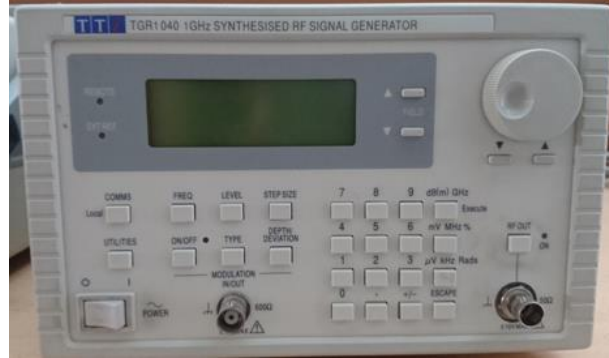
Şekil 1.1. Aim TTI marka TGR1 040 model RF Sinyal Üretici
