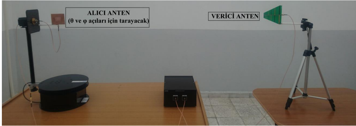
Şekil 7.1. Anten ışıma örüntüsü deney düzeneği.
