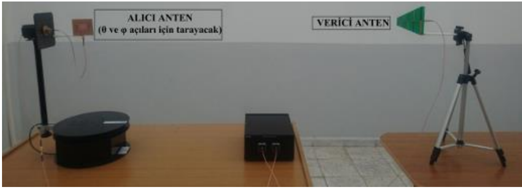
Şekil 2.2. Anten ışınma örüntüsü deney düzeneği.
