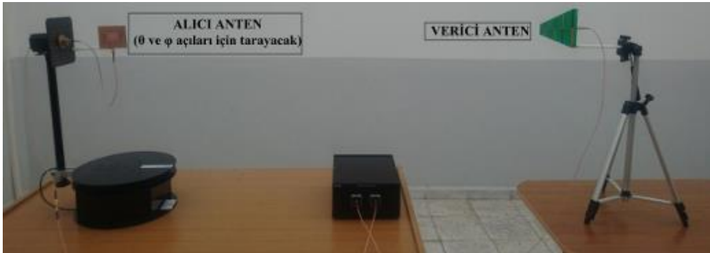
Şekil 2.2. Anten ışıma örüntüsü deney düzeneği.
